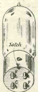
Fig. 5.—Pins of U.V. 199.
